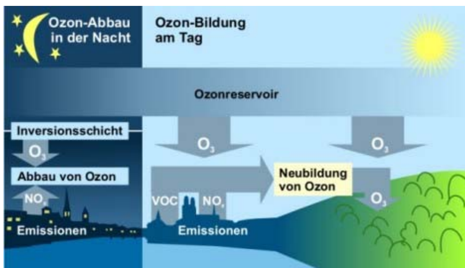
Abb. 1: Prozesse im Tagesgang von Ozonbildung und -abbau
