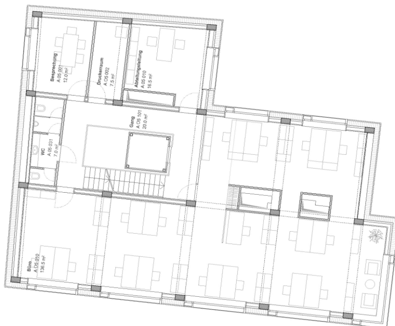
Möblierungsvariante Normalgeschoss mit Mittelkorridor
