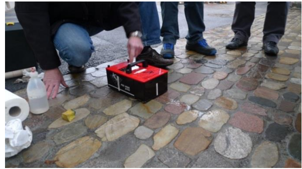
Messung der Gleitsicherheit nach den Normen der Beratungsstelle für Unfallverhütung
