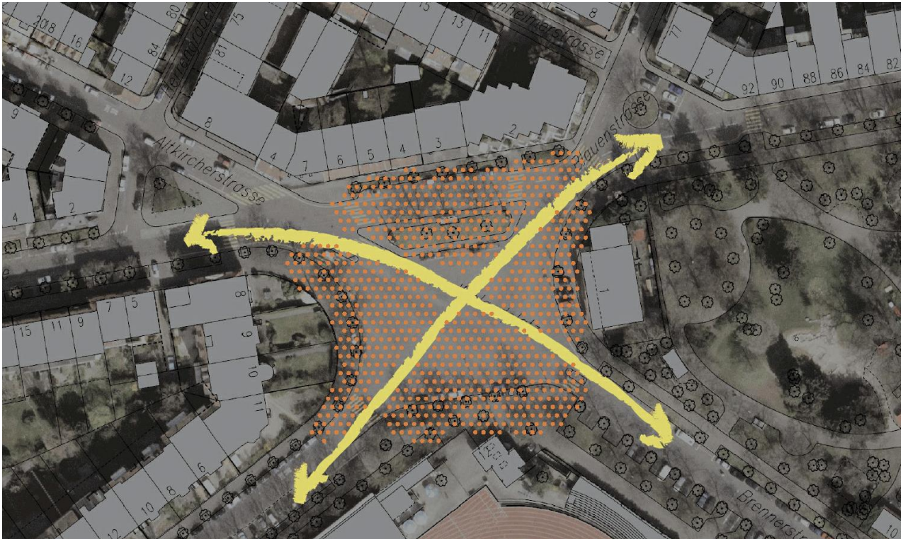
Abbildung 6: Skizze des Betriebskonzeptes für den Wielandplatz mit den Hauptverkehrsbeziehungen (gelb) und dem Potenzial für verkehrsfreie Flächen (orange)
