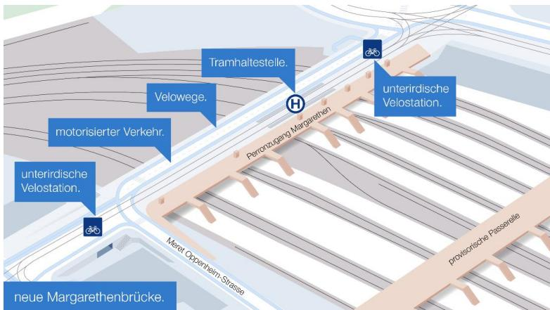
Neue Margarethenbrücke: breiter, mit mittiger Tramhaltstelle und guter Veloquerung (Darstellung SBB)
